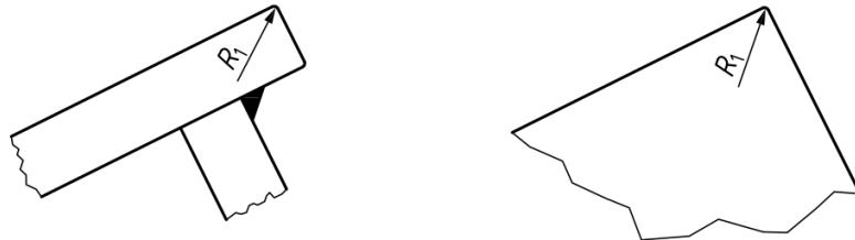
图5 装配型和机加工锥体 \beta 圆周处曲率半径 R_1 示例
